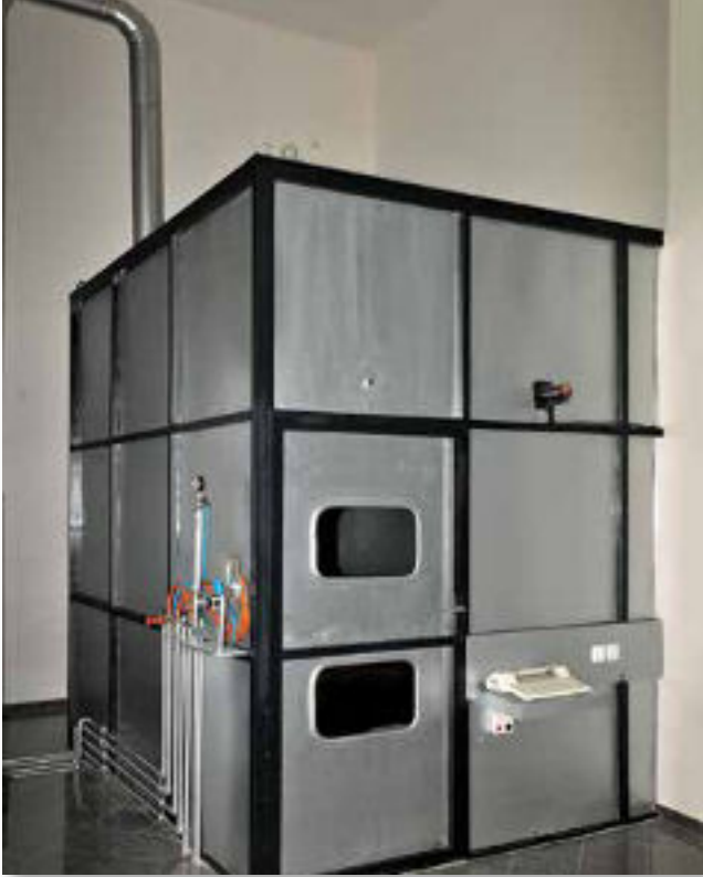
Duman yoğunluğu test kabini.
