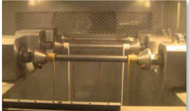
Döngüsel dayanım testindeki kablo numuneleri.
