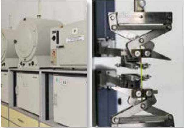
Yaşlandırma testleri için kullanılan fırınlar.
