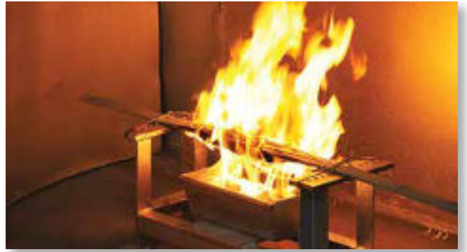
Duman yoğunluğu testinde, yakıt standartlardaki ölçülerde konulmalıdır.
