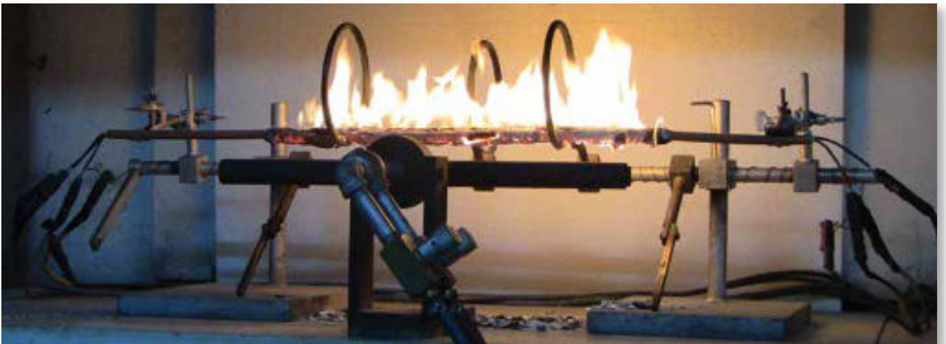
Gerilim altında yanma testindeki bir kablo numunesi.
