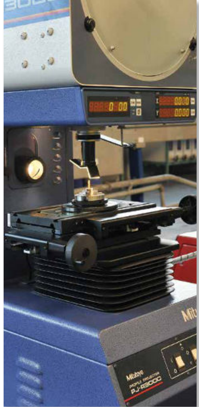
Profil projektör ile geometrik ölçümler yapılır.
