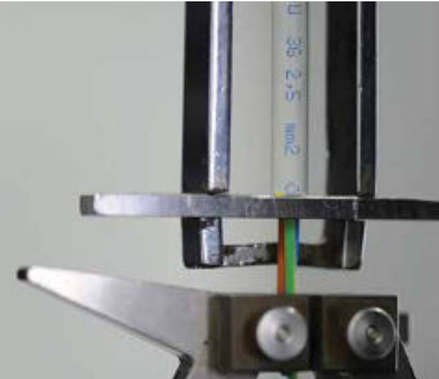
Sıyırma testi altındaki bir numune.
