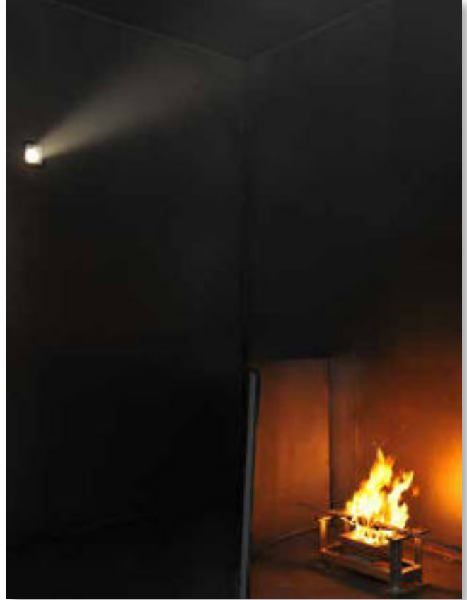
Duman yoğunluğu testindeki bir kablo numunesi.
