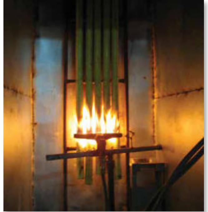
Demetlenmiş kabloların yanması testindeki bir kablo numunesi.
