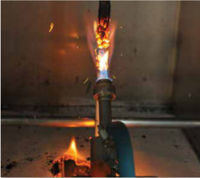
Yanan damlacık testindeki olumsuz bir kablo numunesi.
