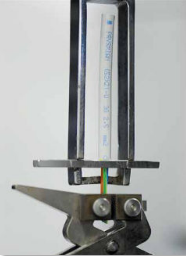
Sıyırılma testindeki bir kablo numunesi.
