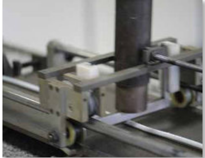
Aşındırma testindeki bir test numunesi.
